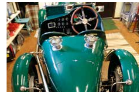
FÖR DEPÅSTOPP. Bakdelen är mycket speciell och att det var en bil avsedd för racing märks inte minst på de dubbla tanklocket - för minimal tankningstid vid depåstopp.
