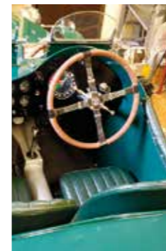
HASTIGHETSMÄTARE. Som den tävlingsbil den är domineras instrumenteringen av en varvräknare. Hastighetsmätare var oväsentlig då, men för att möta registreringskraven monterade Ingvar en GPS som visar exakt hastighet.
