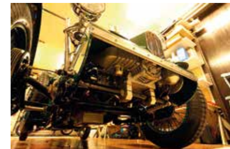
ARBETSKRÄVANDE. Längst fram sitter kompressorn. Den krävde mycket arbete att få på plats och adderar cirka 11 hästkrafter till motorns ursprungliga 54.
