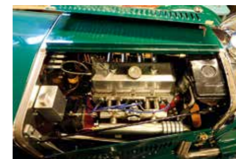
DETALJER. Till skillnad från standardutförande så har Ingvar valt att nyttillverka många detaljer i motorrummet i rostfritt stål - precisionsskuret på en verkstad i Mariestad.
