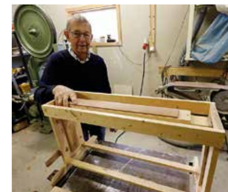
GREPPET. Att få rätt rundning på greppbrädan är en konst i sig. Paul har byggt en specialvagg där han kan ställa in olika rundningar vid bearbetning av gitarrhalsarna.
