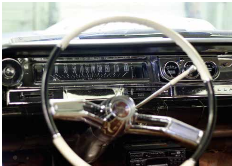
RACERSTYLAD. Instrumenteringen har Christer gjort lite mer racebetonad. Klockan är ersatt med en varvräknare och mekaniska oljetryck- och temperaturmätare passade precis där radion suttit.
