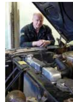
MOTOR. Kraftkällan är originalmotorn, en 390 som dock fått vassare kamaxlar och Tripower-förgasare. – Men ventilhuskåporna från en 429:a kommer nog att förbrylla en del!
