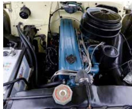
SLITSTARK. En rak Blue Flame-sexa var det häftigaste som erbjöds för Chevrolet Bel Air 1954. Fördelen är att den här ”spisen” i stort sett är outslitlig.
