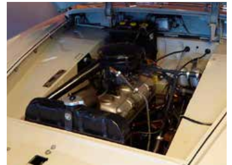
SJÄLVBÄRANDE. Det var rejält med plåt i karosserna på Borgward Isabella. De många luftfickorna visade sig vara problematiska när det gällde rostangrepp, vilket gav märket dåligt rykte.
