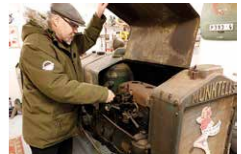
KOMPLETT. – Det är sällan man hittar en så här komplett traktor, speciellt den sällsynta storkraktorn Munktell BM 25, men den här har alla delar kvar, till och med den lilla facklan till tändkulemotorn.
