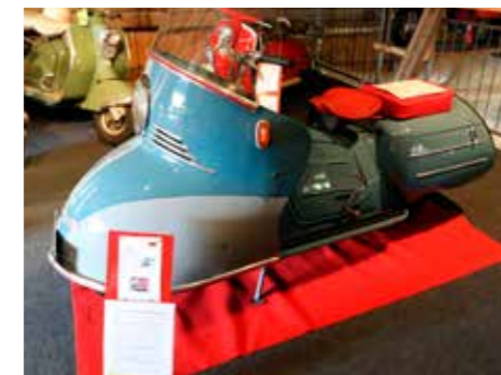
LYX. Designavdelning på steroider? Maico-Mobil MB 200 från 1955 ser tämligen utflippad ut. Helt byggd i aluminium, så de elva hästkrafterna har ändå bara 115 kg - plus förstås förare - att flytta på.
