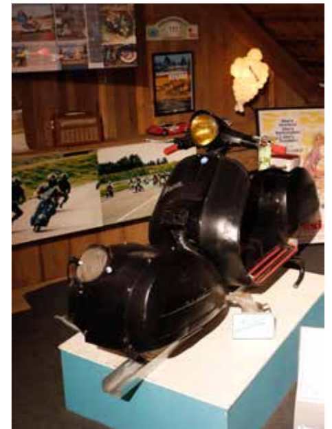
UNIK. Extremt är bara förnamnet på det här specialbygget. Sannolikt världens enda scooter med motorn placerad på framhjulet.
