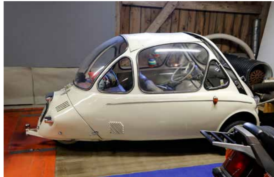
ÅTERVUNNEN. Lite bilar i rätt anda ingår också, till exempel denna Heinkel. – Ett exempel på tidig återvinning, för överdelen var ursprungligen skyttetornet på Heinkels bombplan, berättar Joakim.
